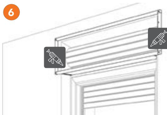
Sigillare tra celino e muro, e l'intero perimetro interno del telaio. Dove predisposto montare l'EPS di compensazione. In caso di manovra manuale, inserire il cintino nel guidacinghia del telaio.
